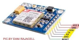
Gambar 13. Modul SIM800L V.2
