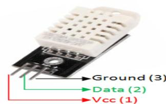
Gambar 3. Konfigurasi Pin DHT22
