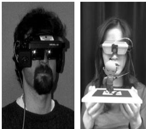
Gambar 3. Penggunaan HMD dalam sistem AR[3]
