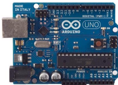
Gambar 3. Bentuk fisik Arduino UNO
