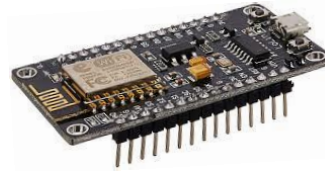
Gambar 4. Bentuk fisik NodeMCU
