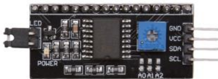
Gambar 3. Bentuk fisik I2C
