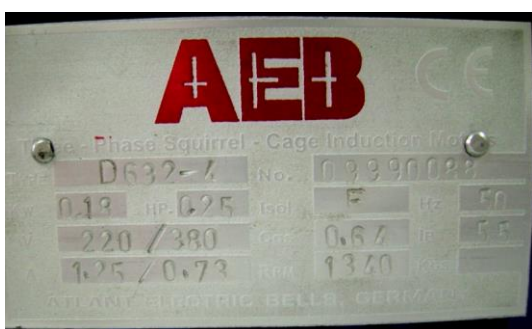
Gambar 2. Name plate Motor Induksi
