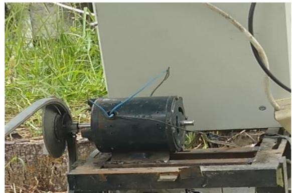
Gambar 1. Bentuk fisik generator sinkron magnet permanen satu fase
