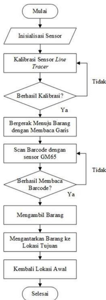
Gambar 3.5 Diagram Alir Prinsip Kerja Robot
