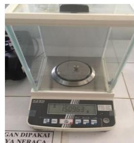
Gambar 8 Menimbang massa jenis bola viskometer
