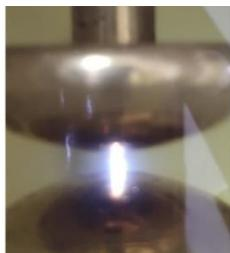
Gambar 3 Tegangan Tembus Saat Pengujian
