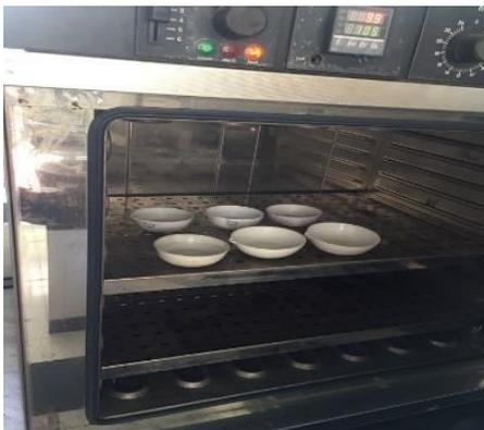
Gambar 5 Pemanasan sampel minyak pada pengujian kadar air menggunakan oven
