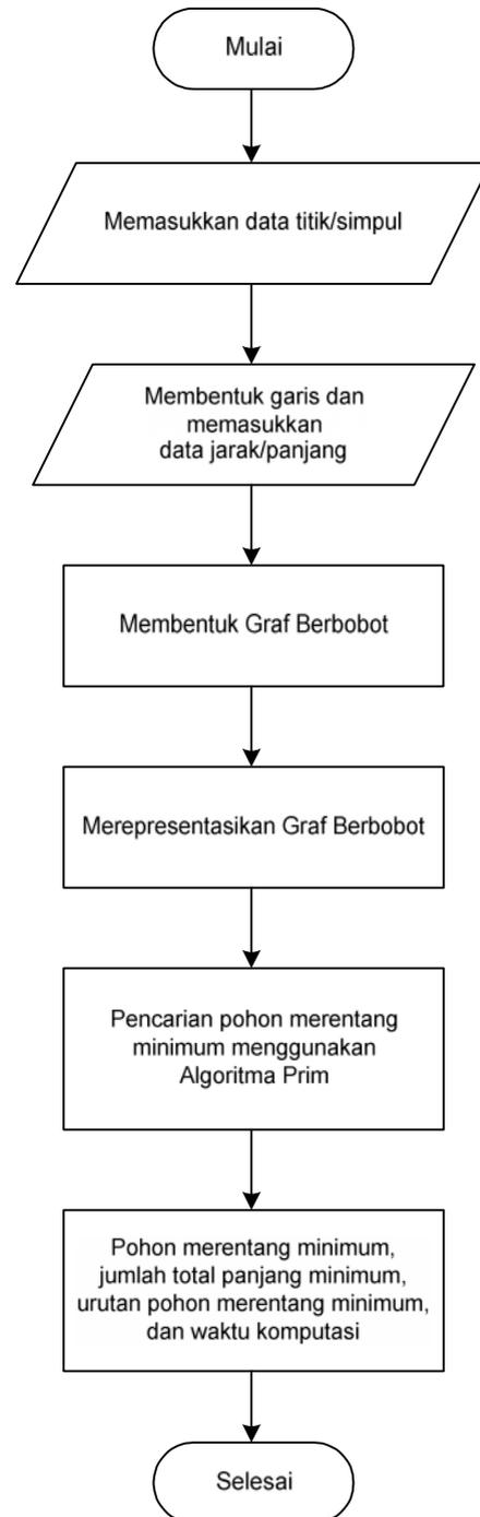
Gambar 5. Flowchart tahapan pencarian pohon merentang minimum dengan menggunakan algoritma Prim
