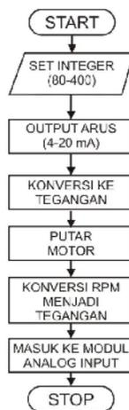
Gambar 9. Flowchart Rangkaian pengendali kecepatan motor
